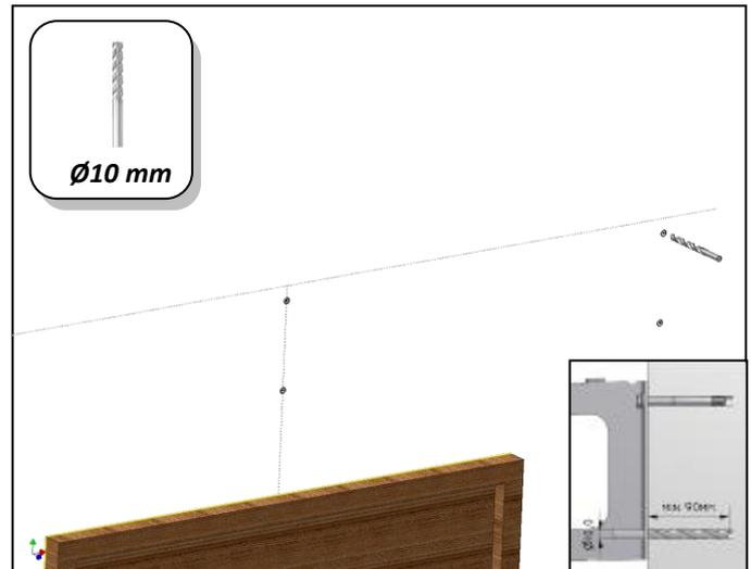
**DK:** Bor hullerne op med et Ø10 mm mur bor, til medfølgende ekspansions bolte (P05). Min. 90 mm. Boltene til fastgørelse kan kun bruges til beton og massive murstens vægge. Hvis udhænget skal hænges op på andet underlag skal anden befæstigelse anskaffes.
